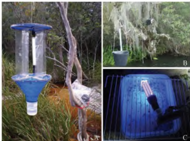
Figura 11. A. Armadilha Pennsylvania. B. Luz em balde coletor. C. Luz UV em bandeja coletora.
