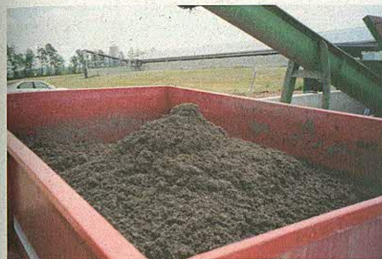
Figura 22. Fração sólida separada dos dejetos de suínos por meio de equipamento de peneira com prensa.
