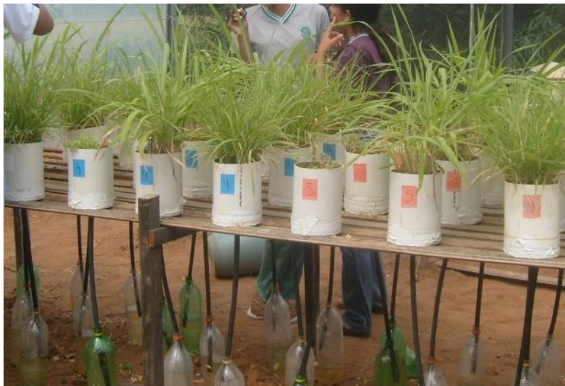
Figura 1. Detalhe da bancada com os recipientes e os drenos conectados as garrafas PET's
