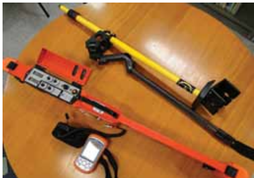
Figura 3. sistema medida de condutividade elétrica por indução eletromagnética, EM38-MK2
