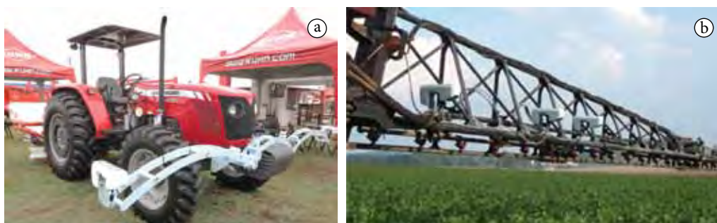
Figura 3. (a) Sensor de clorofila GreenSeeker®. Foto: Ricardo Inamasu, e (b) Instalação do sensor para aplicação de insumos em ATV. Foto GreenSeeker®
