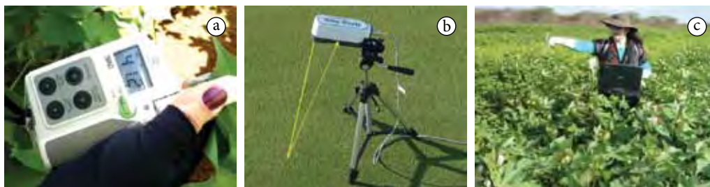
Figura 2. (a) Sensor de contato direto para medição dos teores de clorofila foliar (Clorofilômetro portátil da Minolta®), (b) Sensor óptico ativo Crop Circle®, (Foto: Holland Scientific.) e (c) Espectrorradiômetro passivo da Apogee®, utilizados na cultura do algodoeiro. Fonte: Brandão, 2009.
