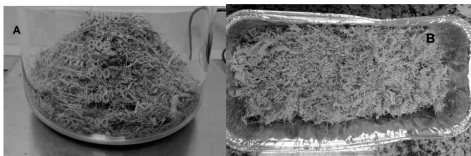
Figura 1. Amostras de ráquis antes (A) e após (B) o branqueamento.
