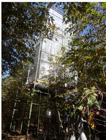
Câmara utilizada na marcação de árvore de eucalipto com ^{13}\text{C} -CO 2
