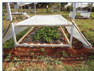
Figura 1. Estrutura galvanizada que suporta o conjunto de lâmpadas do simulador de aumento de radiação UV-B no campo.
