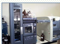
Cromatógrafo Líquido com Detector de Massas (UPLC-MS/MS)
