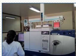
Cromatógrafo Gasoso com Detector de Massas (GC-MS/MS)
