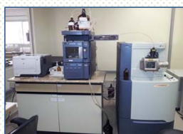
Cromatógrafo Líquido acoplado a Espectrômetro de Massas - QqTOF-MSMS
