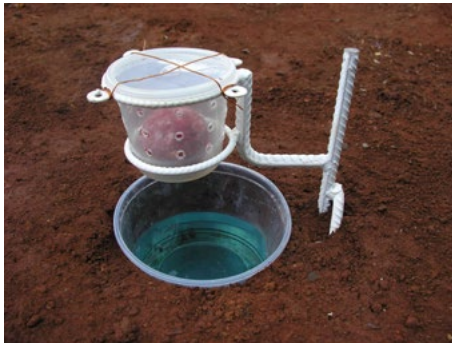
Figura 26. Armadilha de queda sem proteção.
