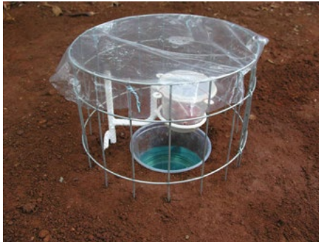
Figura 25. Armadilha de queda instalada com proteção.
