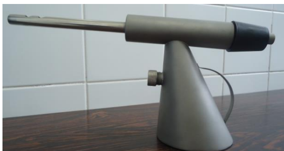
Figura1: Acidímetro de salut (pistola do álcool) utilizado pelo transportador.
