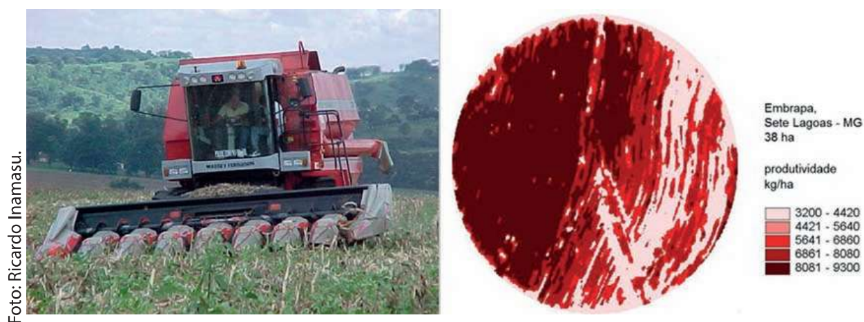
Figura 2. Primeiros modelos de colhedora no mercado brasileiro com monitor de colheita em campo experimental da Embrapa Milho e Sorgo em 2000.
