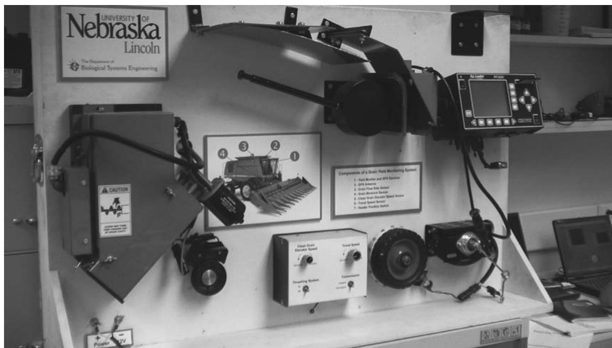
Figura 3. Sistema instalado em colhedoras para mapeamento da produção.
