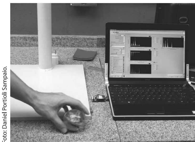
Figura 3. Esfera instrumentada – fruta eletrônica – desenvolvida em parceria entre a Embrapa Instrumentação e a Unicamp.
