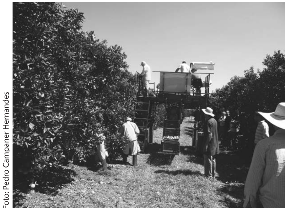
Figura 2. Destaque para a escada de acesso traseira e o local para armazenamento das caixas de colheita.
