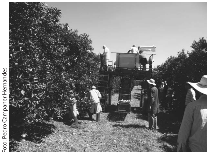
Figura 2. Destaque para a escada de acesso traseira e o local para armazenamento das caixas de colheita.
