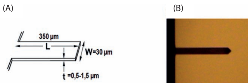
Figura 7. (A) Diagrama esquemático dos parâmetros geométricos do microcantilêver; (B) imagem do microcantilêver de silício retangular.
