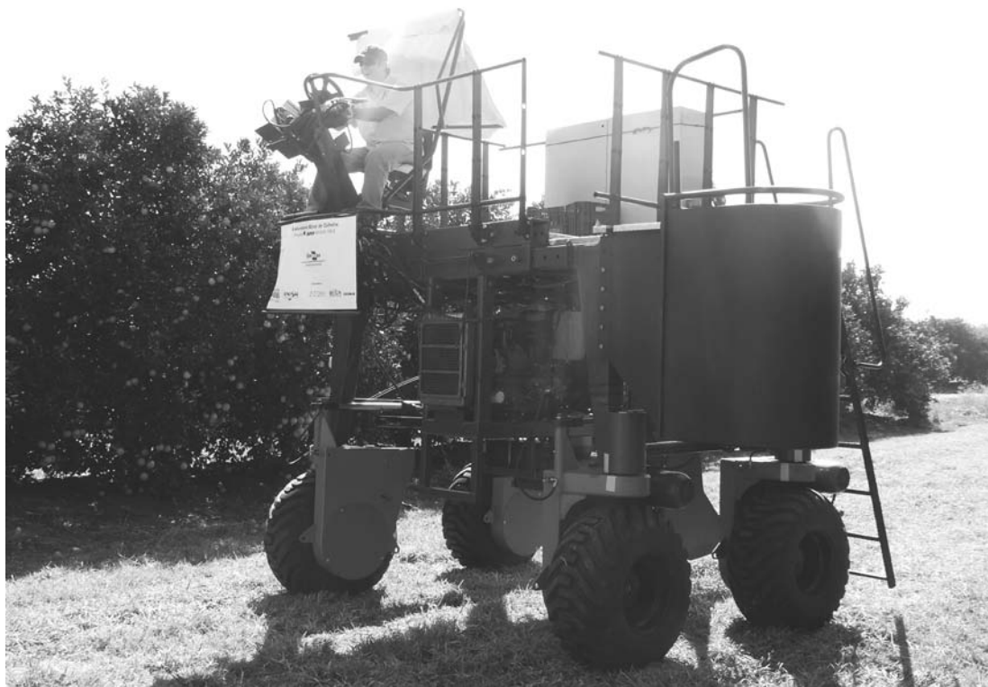
Figura 1. Parte frontal da máquina com motogerador na parte central e gôndola lateral.
