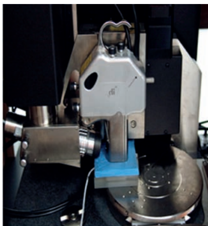
Figura 9. Microscópio de força atômica com a câmara de acrílico acoplada.
