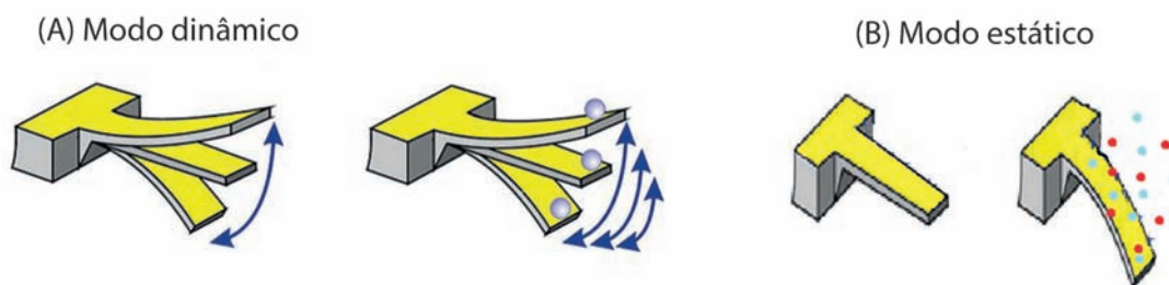
Figura 6. Representação esquemática dos dois modos de operação do microcantilêver (TABBARD-COSSA, 2005), A) mudança da f_{res} devido à mudança da massa efetiva e B) tensão superficial devido à adsorção de moléculas.
