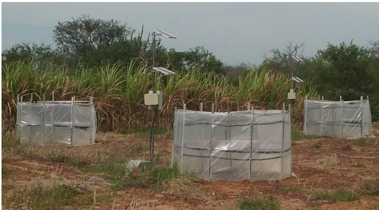
Figura 1. Detalhe das câmaras de injeção de CO<sub>2</sub>.
