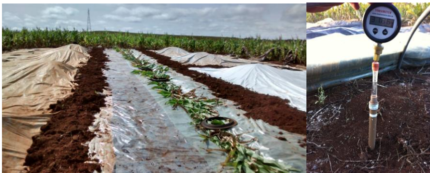
FIGURA 1. Área de teste, com detalhe da cobertura com lona e um dos tensiômetros de monitoramento da umidade do solo.
