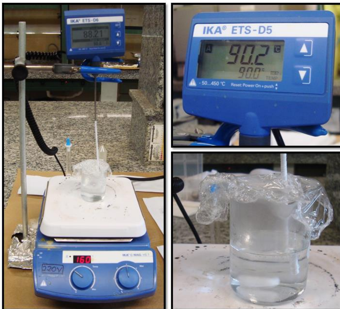
Figura A.2 - Síntese das nanopartículas de prata sob agitação magnética e aquecimento a 90°C por cerca de 4 minutos.
