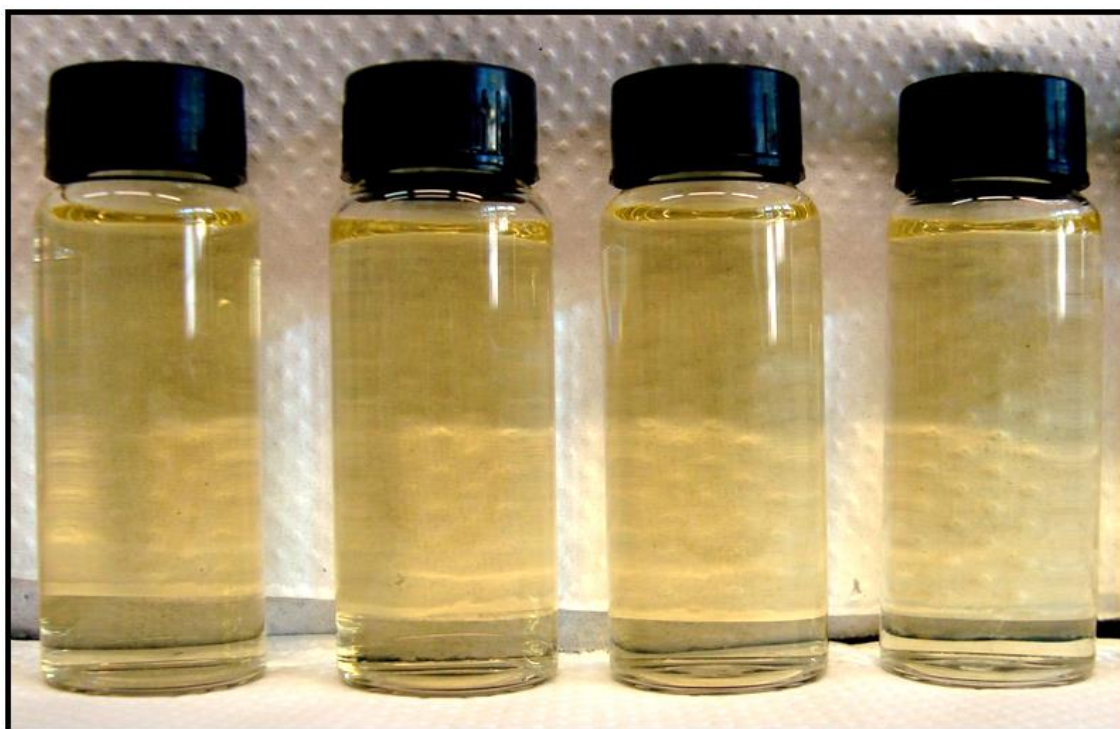
Figura 4.1 - Solução coloidal de nanopartículas de prata com tonalidade amarela âmbar, que é um dos indicativos da formação destas nanopartículas.
