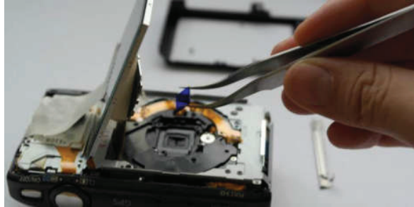
Figura 7 – Substituindo o Filtro em uma câmera RGB.
