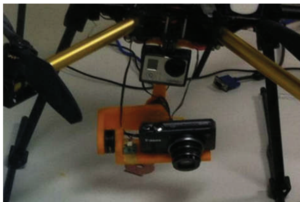
Figura 8 - Em laranja, o Gimbal impresso utilizando uma impressora 3D.
