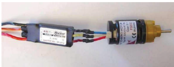
Figura 1 - ESC conectado ao motor brushless .
