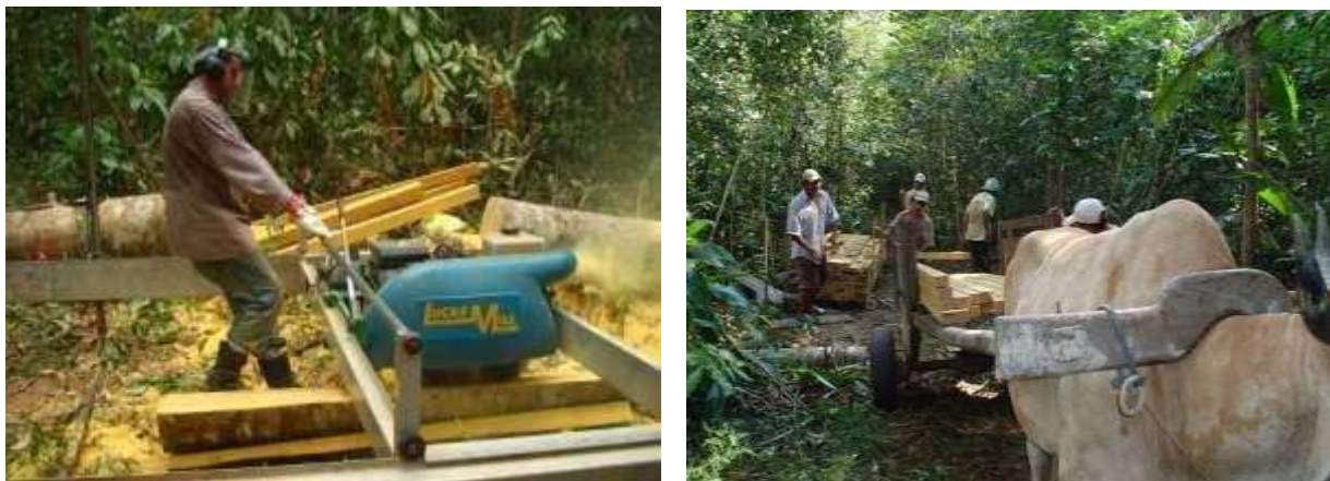
Figura 1. Sistema de manejo florestal comunitário do Projeto de Colonização Pedro Peixoto-AC: (a) e (b) transporte primário da madeira serrada com animal utilizando a “zorra”, (c) processamento da madeira com serraria portátil e (d) transporte primário com carroça em carreador central às áreas de manejo florestal.
