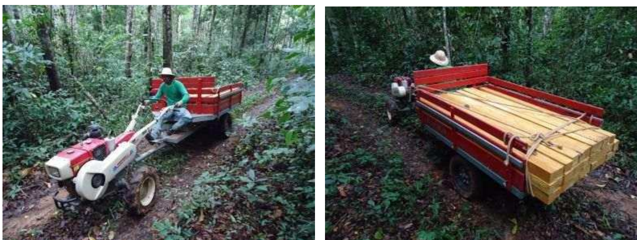
Figura 2. Transporte primário da madeira com micro trator e reboque do sistema de gestão comunitária da floresta da Colonização Peixoto Pedro Projeto-AC.
