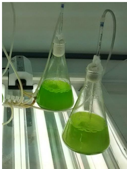
Figura 5. Frascos erlenmeyer com aeração utilizados para o cultivo de microalgas.
