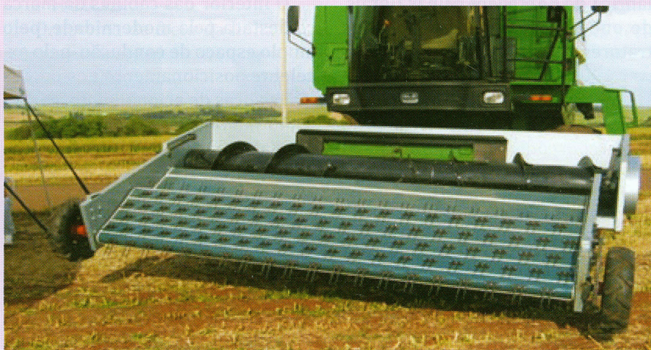
Protótipo de uma plataforma equipada com mecanismo recolhedor com esteira Produfort, para o recolhimento de leiras de canola
