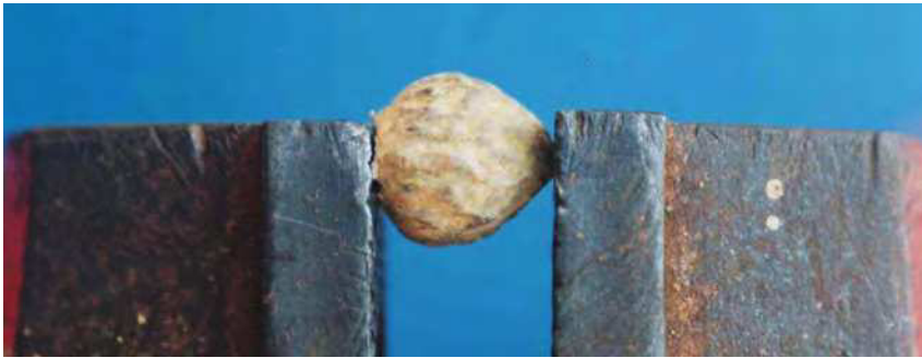
Figura 9. Compressão para provocar fratura no endocarpo em pirênio do muruci.
