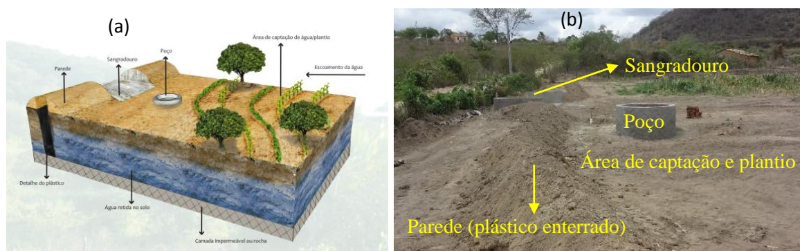
Figura 1- Desenho esquemático do funcionamento de uma barragem subterrânea (a) e Barragem subterrânea em área de agricultor no Semiárido do estado de Pernambuco, município de Pedra, PE, 2014 ((b). Desenho: Jhones Gomes Lopes. Foto: Maria Sonia Lopes da Silva.
