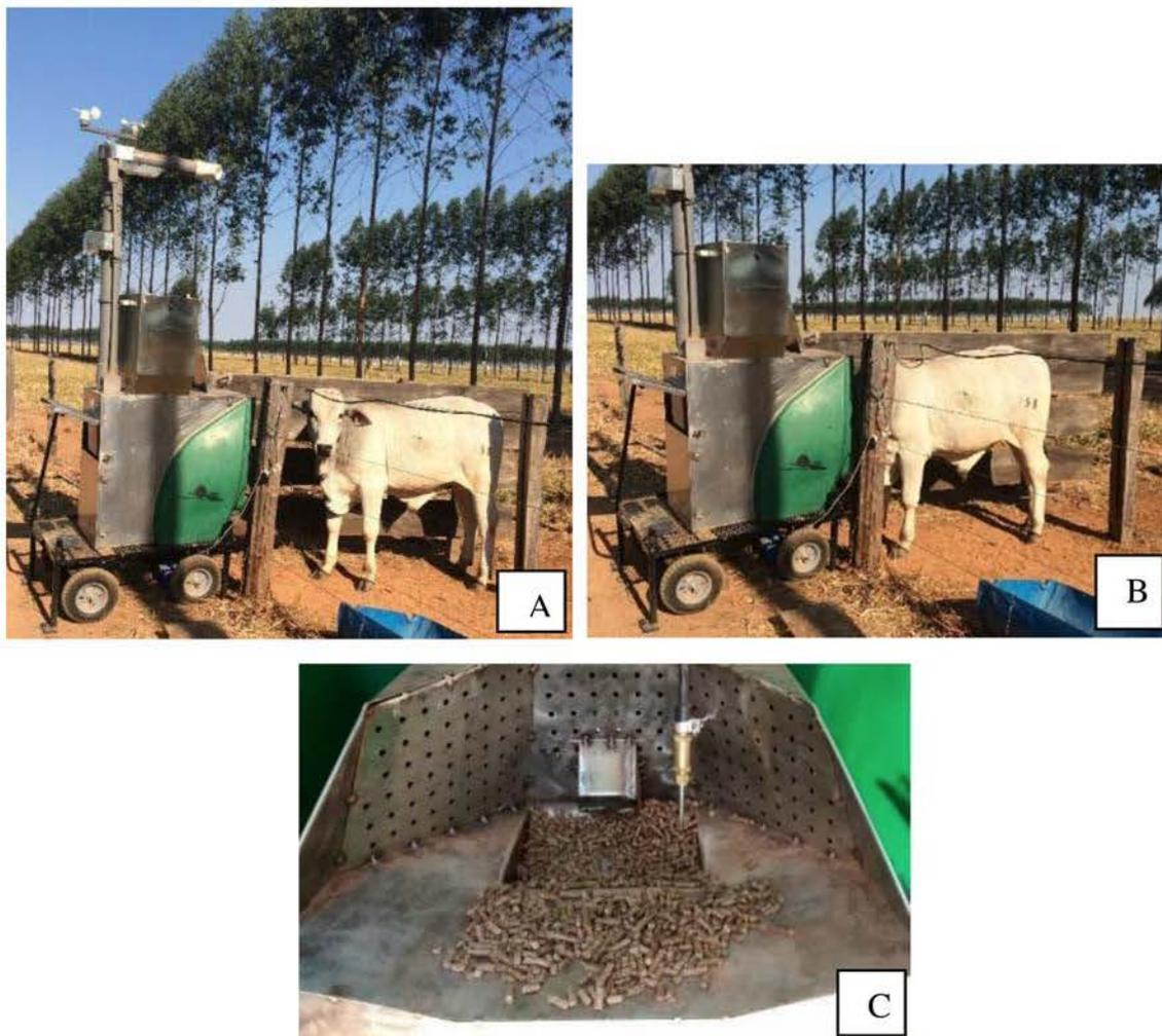
**Figura 3.** Medição de metano via GreenFeed®. A. Equipamento; B. Detalhe do animal no equipamento sem a interferência humana; C. Detalhe do cocho e do alimento utilizado como atrativo para encorajar o animal a visitar o equipamento.
