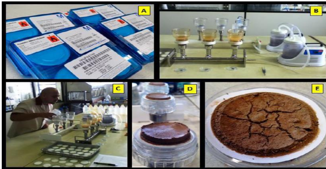
Figura 3: (A) Filtros de celulose, (B) Manifold para filtração dos sedimentos, (C) Processo de filtração, (D) Sedimentos retidos no filtro e (E) Sedimentos pós-estufa pronto para ser pesado.
