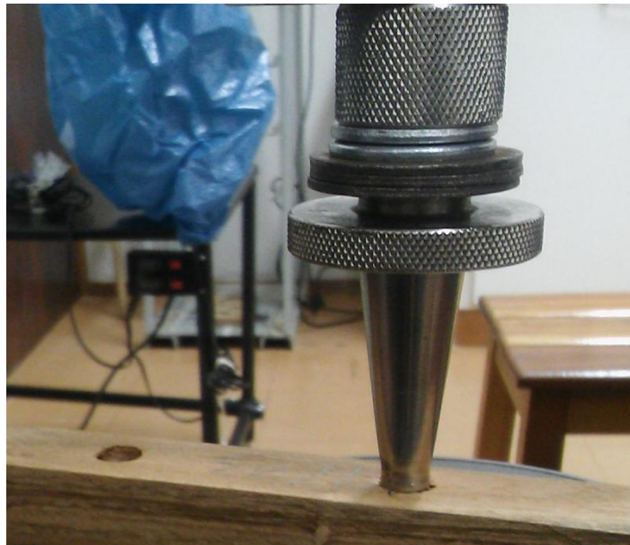
Figura 12. Ensaio de dureza Janka
