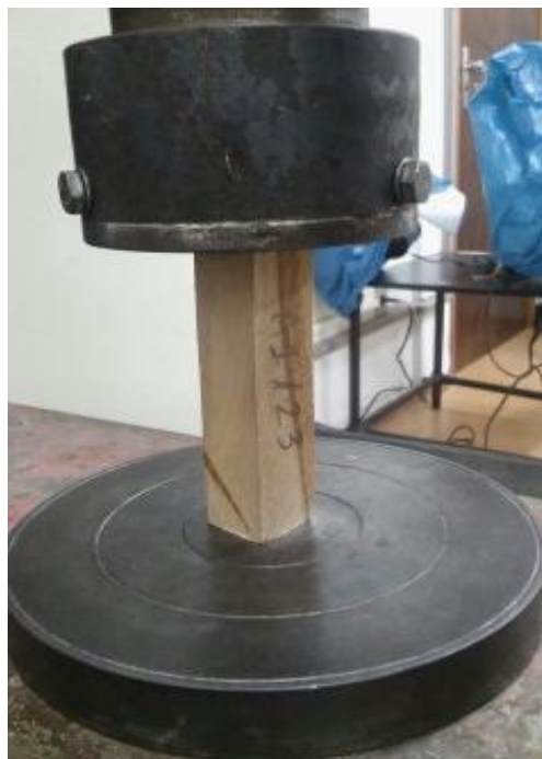
Figura 10. Ensaio de compressão paralela às fibras
