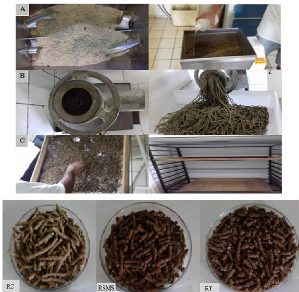
Figura 5. Imagens do preparo das rações para nutrição dos juvenis da Tambacu. A) Mistura dos ingredientes da ração; B) Peletização; C) Secagem dos pellets. D) Rações pelelitizadas: RC= Ração Controle; RSMS= Ração com SMS; Ração com Torta de Dendê.
