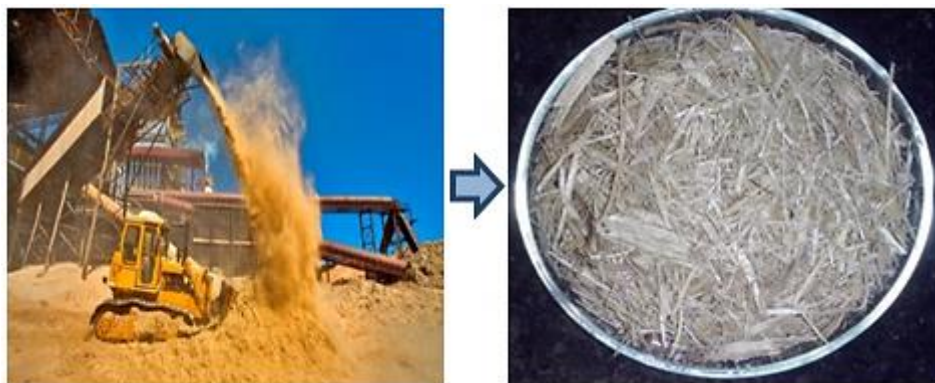
Figura 2: Bagaço de cana gerado na indústria após moagem. 4
