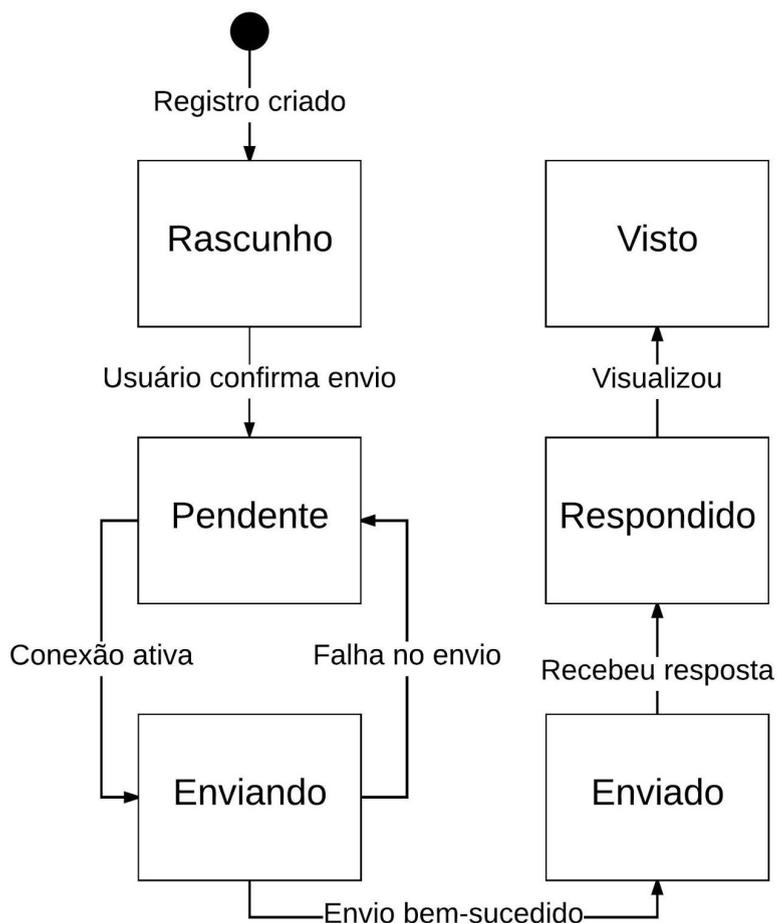
**Figura 4.** Esquema representando as transições de estados do registro.
