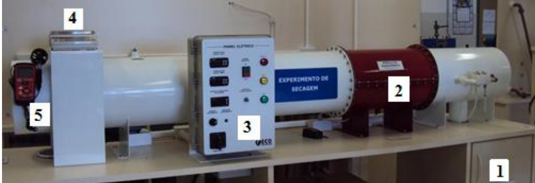
Figura 2: secador de leito fixo com escoamento de ar paralelo. (1) soprador centrífugo, (2) trocador de calor, (3) painel de controle, (4) balança digital e (5) anemômetro de ventoinha.
