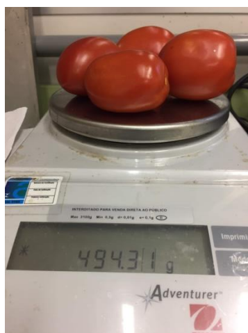
Figura 8. Avaliação da perda de massa dos tomates em balança analítica
