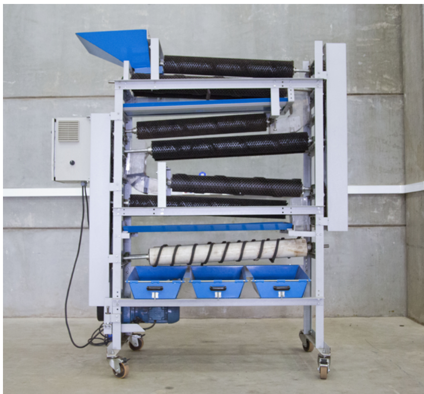
Figura 16. Classificador compacto vertical para frutas e hortaliças. Foto: Luiza H. de M.Stalder.
