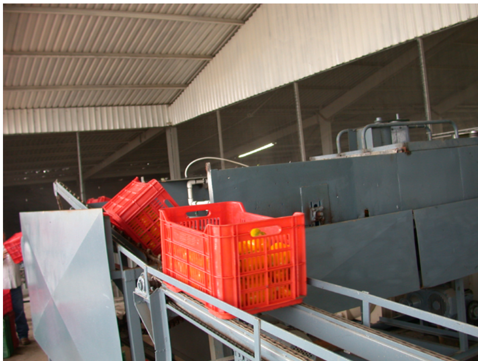
Figura 14. Etapa de recebimento realizada automaticamente em linhas de beneficiamento. Foto: Steven A. Sargent.
