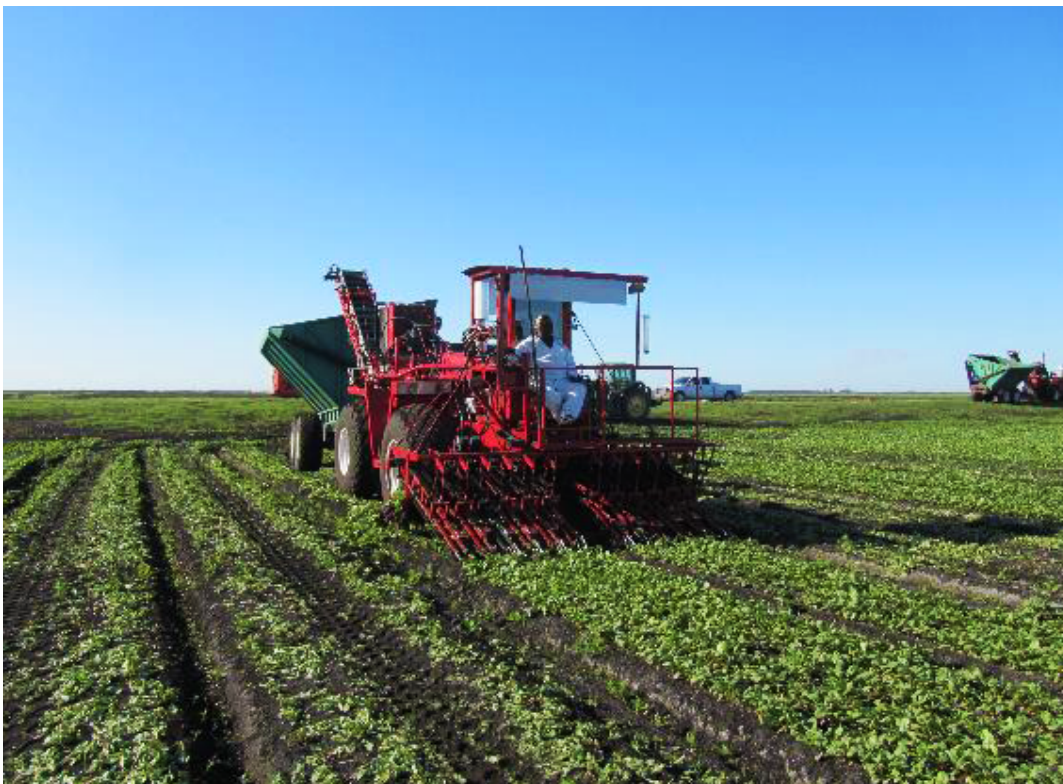
Figura 7- Colheita mecânica de rabanete. Obs: a máquina separa a raiz da planta. Vista frontal do equipamento. Foto: Steven A. Sargent.
