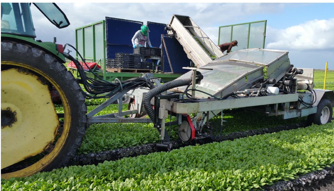
Figura 8- Colheita de espinafre em estágio inicial – baby spinach. Vista lateral do equipamento de colheita. Foto: Steven A. Sargent.
