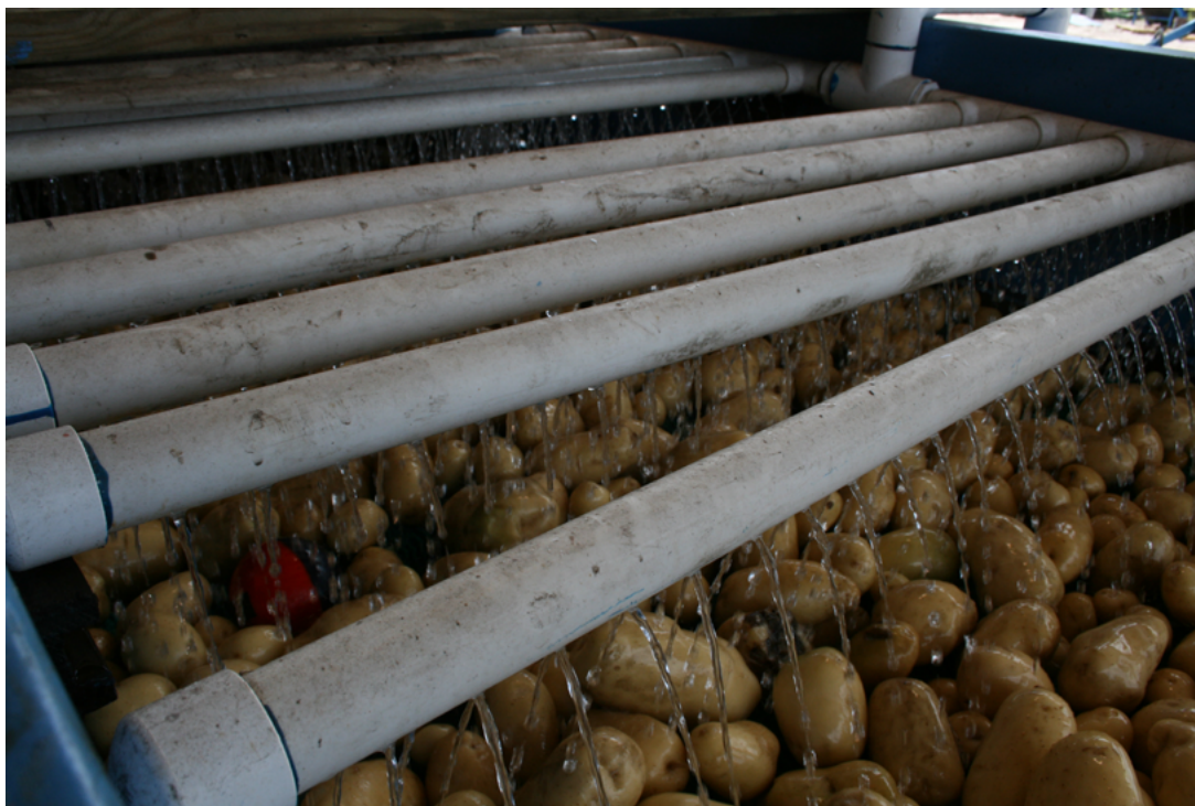
Figura 15. Lavagem e enxágue de batatas na linha equipada com escovas giratórias em etapa anterior à secagem. Foto: Steven A. Sargent.
