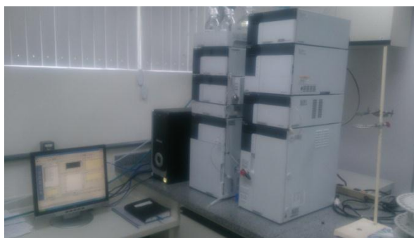
Figura 14: Equipamento de CLAE utilizado para as análises
