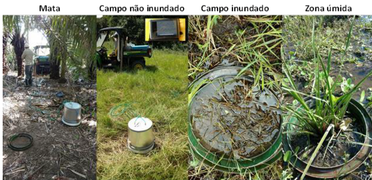
Figura 2. Medidas de fluxo de gases com câmaras estáticas e anéis de vedação.
