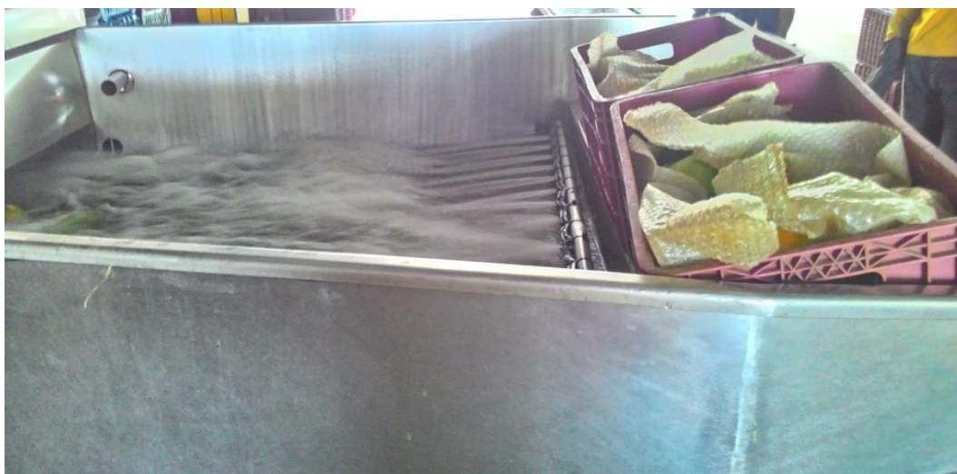
Figura 3. Entrada dos frutos no tanque de lavagem com esguichos que favorecem a movimentação dos frutos. Foto: Fabiana Fumi Cerqueira Sasaki
