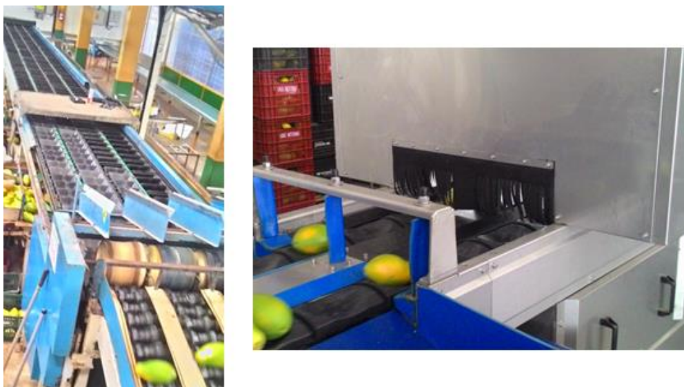
Figura 6. Classificador automático com bandeja individuais (A) e detalhe do equipamento para classificação por coloração da casca (B). Fotos: Fabiana Fumi Cerqueira Sasaki.
