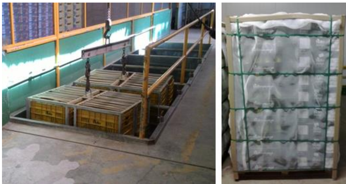
Figura 8. Tratamento hidrotérmico dos frutos, em ambiente telado (A) e paletes telados preparados para exportação para os Estados Unidos (B). Fotos: Fabiana Fumi Cerqueira Sasaki
