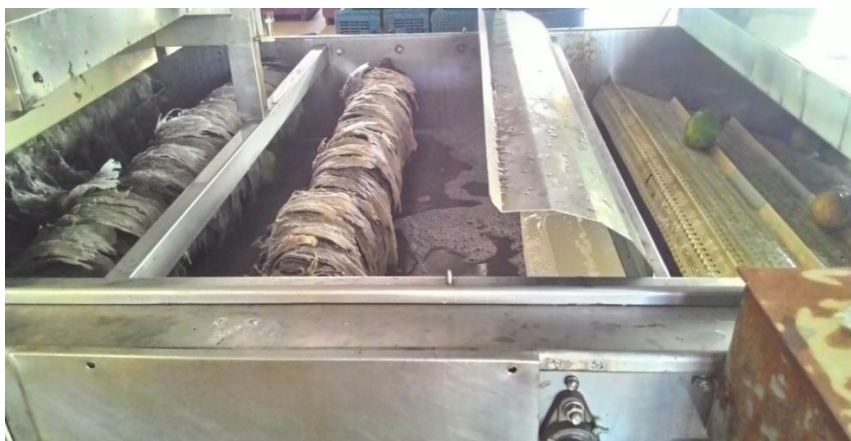
Figura 4. Detalhe das cerdas para limpeza dos frutos. Foto: Fabiana Fumi Cerqueira Sasaki.
