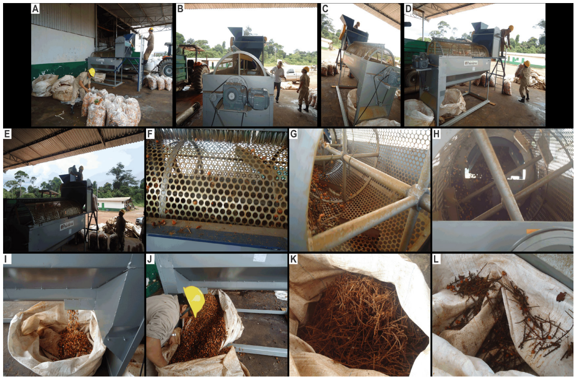
Figura 8 – Sequência de imagens dos testes com o primeiro protótipo de Desracemador mostrando vista geral do equipamento com os preparativos para os testes (a, b, c, d, e), detalhes do cilindro/batedor com peneiras (f, g, h), frutos livres dos racemos (i, j) e, racemos separados (k, l).
