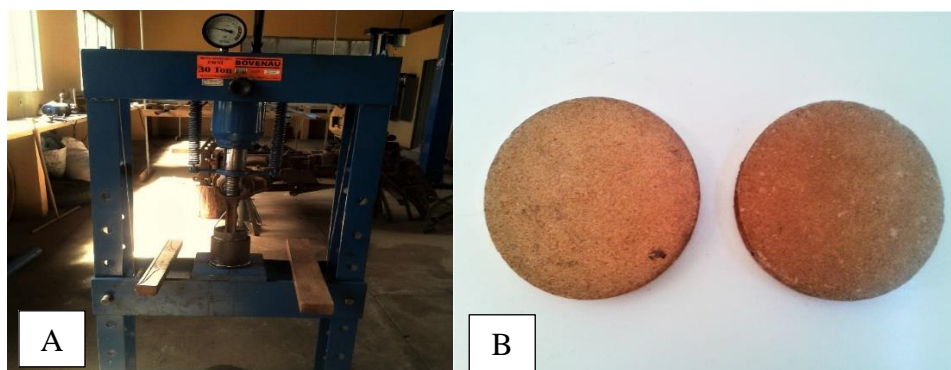
Figura 1. Fig. 1A – Processo de compactação dos briquetes; Fig. 1B – Briquete à esquerda com aglutinante de amido de milho e briquete à direita com aglutinante de papel.
