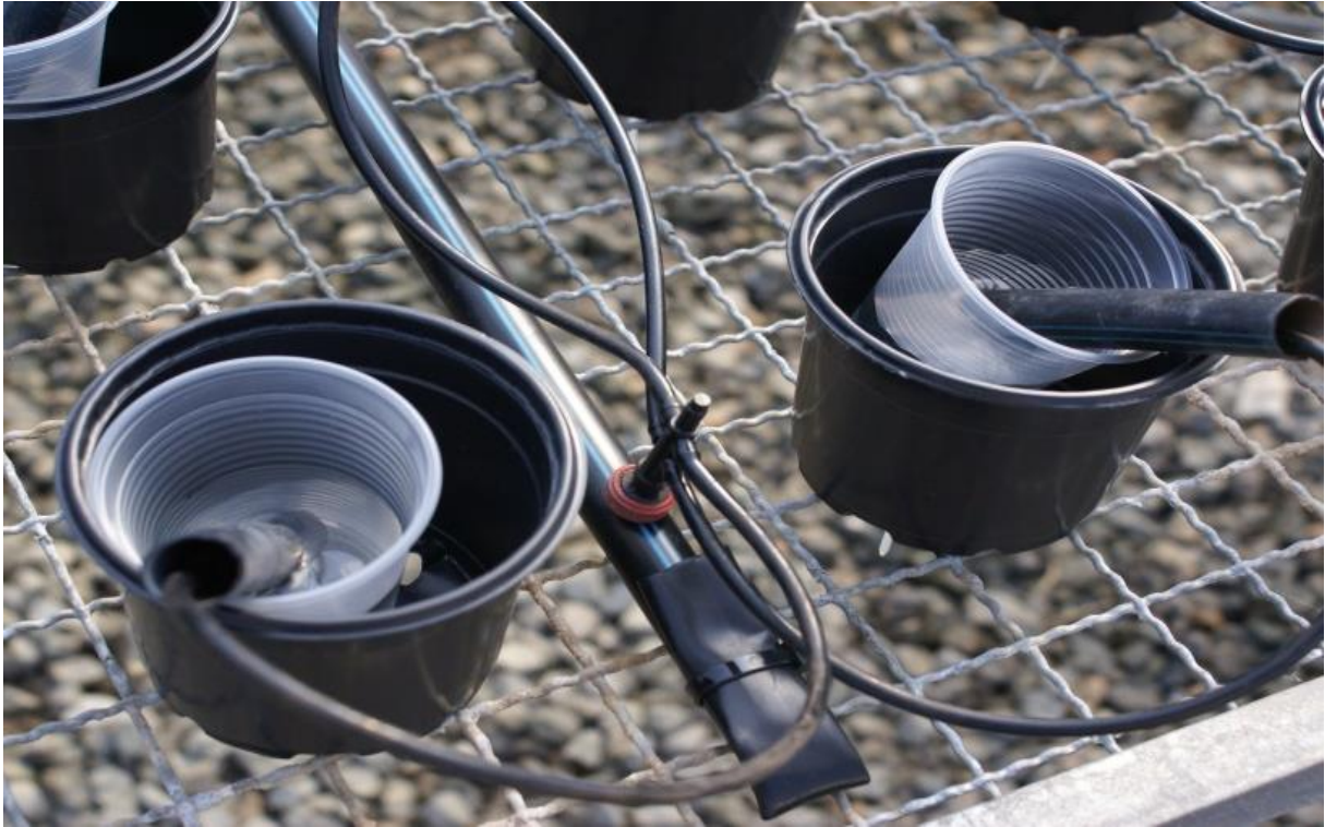
Figura 9 – Teste de uniformidade de distribuição para o sistema de irrigação instalado na área experimental. Embrapa Agroindústria Tropical, Fortaleza, Ceará, 2016
