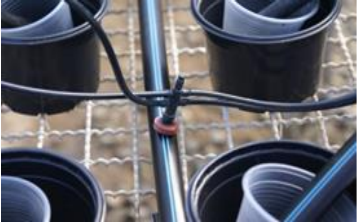
Figura 8 – Conjunto “aranha” composto de gotejador autocompensante com vazão de 2 \text{ L h}^{-1} , manifolds de quatro saídas e microtubos de 2,4 mm. Embrapa Agroindústria Tropical, Fortaleza, Ceará, 2016
