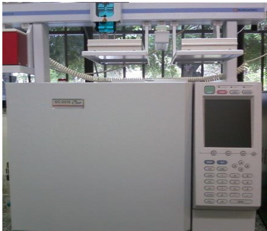
Figura 8 – Cromatógrafo à gás com detector de ionização de chama (CG-DIC). Shimadzu GC-2010.
