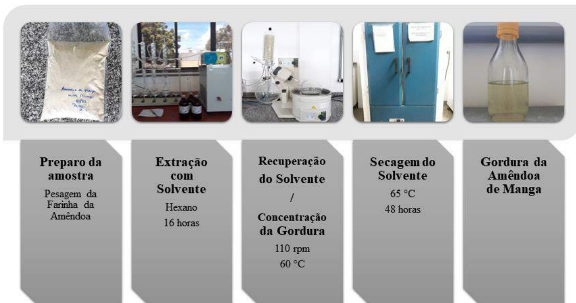
Figura 7 – Esquema do processo de extração da gordura de amêndoa de manga.
