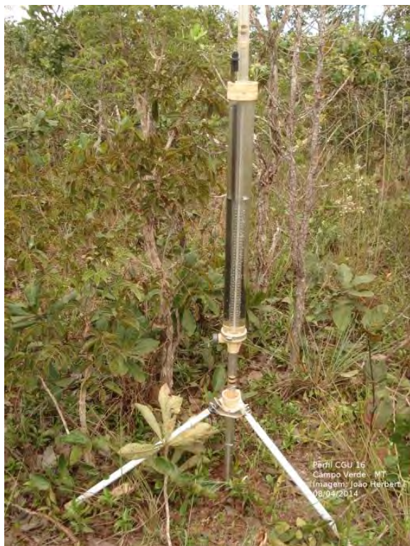
Figura 1. Permeâmetro de Guelph, instrumento usado para avaliar a taxa de infiltração de água de camadas de solos.
