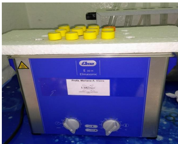
Figura 3 Banho ultrassônico utilizado na extração ácida do xisto retortado para a determinação de As por HG AAS.
