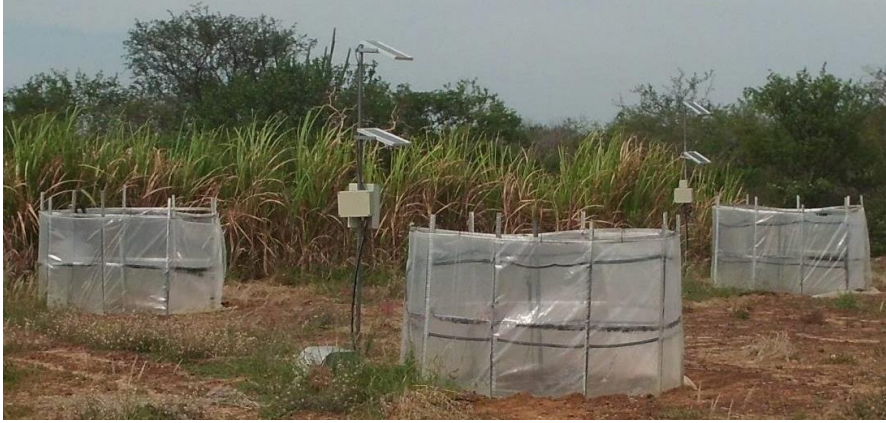
Figura 2.1 - Detalhe das câmaras de injeção de CO 2 .
