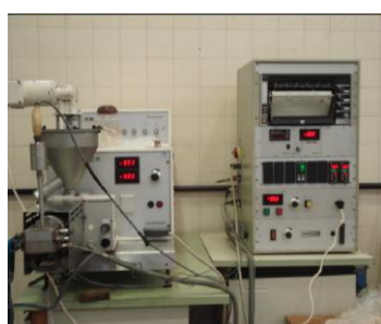
Figura. Extrusora Brabender
