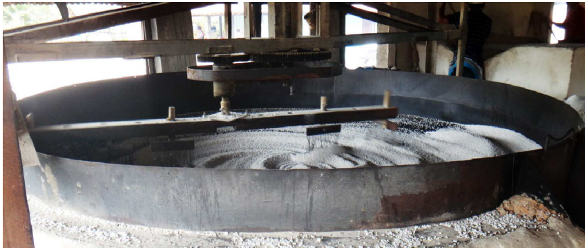
Figura 4. Forno mecânico utilizado para torragem e/ou espocamento da farinha de tapioca.
