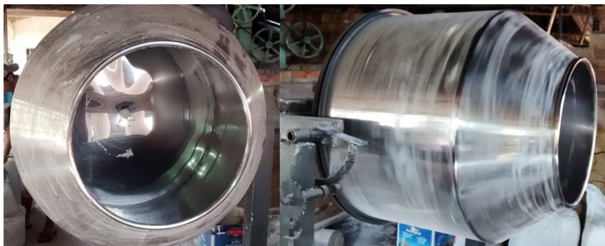
Figura 2. Encaroçadeira tipo betoneira em aço inoxidável, sem as aletas de turbilhonamento, utilizada para encaroçamento da tapioca.
