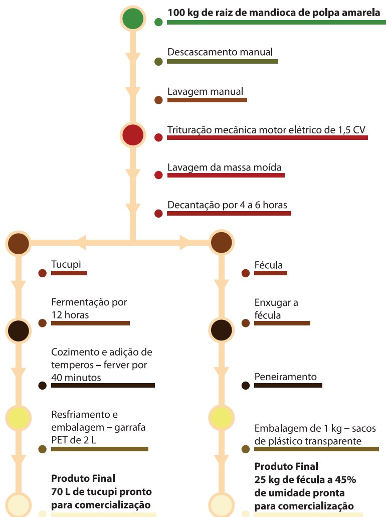
Figura 4. Fluxograma de processamento do tucupi e da fécula a 45% de umidade, no município de Santa Izabel do Pará. Abril, 2016.
