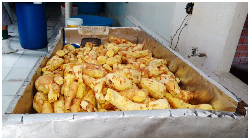
Figura 1. Raízes descascadas e lavadas prontas para a etapa de trituração. Abril, 2016.
