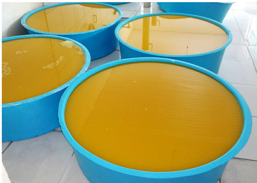
Figura 3. Manipueira em descanso por cerca de 4 a 6 horas para decantação do amido.
