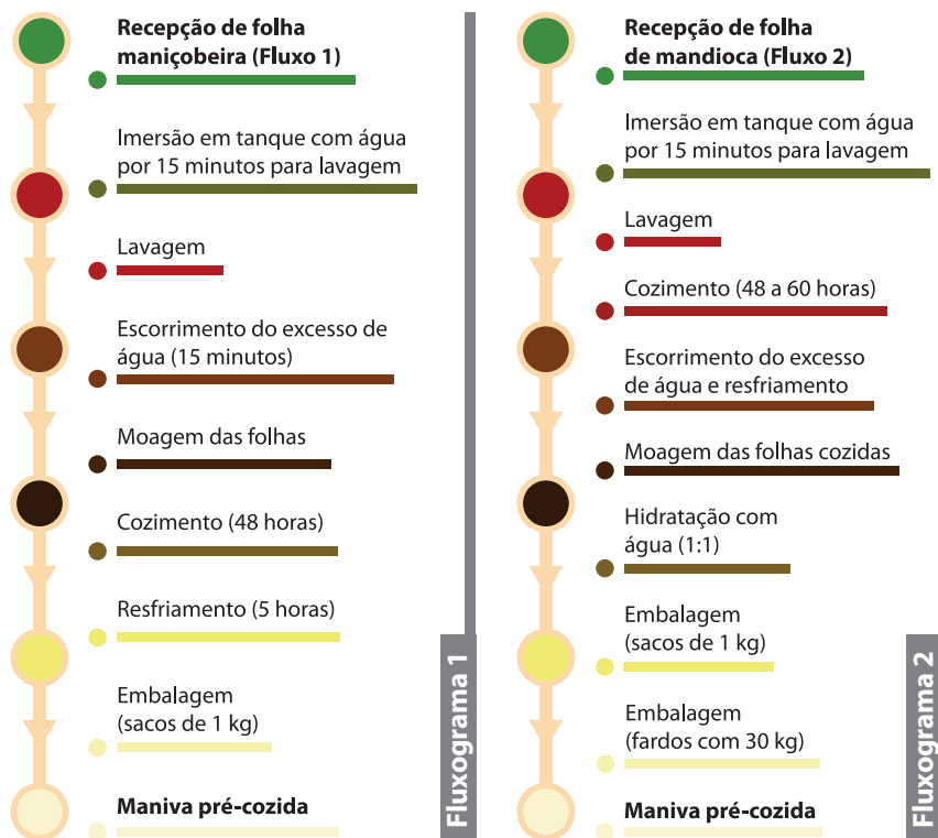
Figura 1. Fluxogramas de processamento de maniva pré-cozida oriunda de folhas de maniçoeira (Fluxograma 1) e mandioca (Fluxograma 2).
