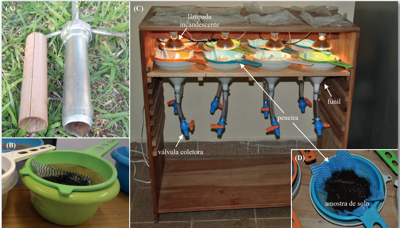
Figura 5.1. Métodos de extração de enquitreídeos. (A) Trado coletor de solo, desmontável, do tipo split corer , com tubo de PVC (à esquerda), que se acopla internamente. (B) Método de extração fria, onde a amostra de solo, depositada em uma peneira, fica submersa em uma bacia com água, por vários dias. (C) Método de extração a quente, onde uma lâmpada incandescente aquece a superfície da amostra de solo, em uma peneira encaixada em um funil com água. Acoplada ao funil, na porção inferior, uma mangueira transparente e uma válvula, permitem a coleta de enquitreídeos que se depositam na extremidade inferior, após algumas horas. (D) Vista superior das amostras de solo no extrator quente.
