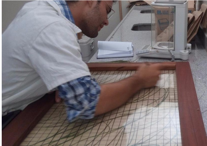
Figura 4. Determinação do índice de área foliar por meio da chapa de vidro quadriculado
