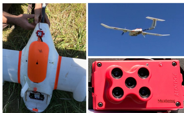
Figura 2. Detalhes dos equipamentos utilizados: corpo central do RPA de asa fixa (imagem à esquerda); RPA em voo (superior à direita), e sensor RedEdge-M® utilizado (inferior à direita). Fotos: Naylor B. Perez.
