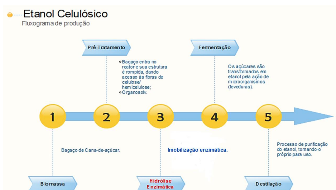
Figura 5. Fluxograma de produção de etanol de segunda geração.
