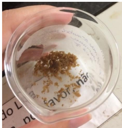
Figura 19. Coquetel enzimático imobilizado em quitosana ativada com glutaraldeído.
