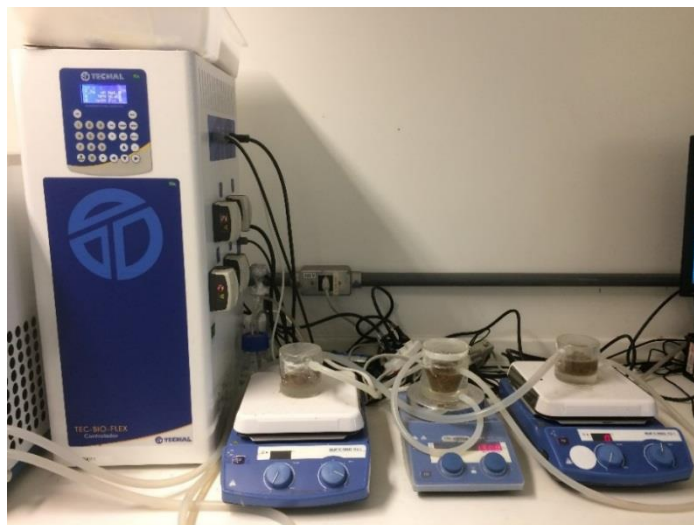
Figura 14. Esquema da unidade reacional utilizada na hidrólise enzimática.
