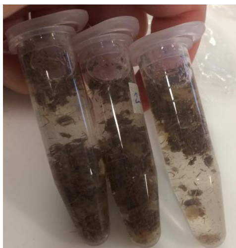
Figura 15. Tubos de hidrólise utilizados na hidrólise da biomassa durante o ajuste dos parâmetros
