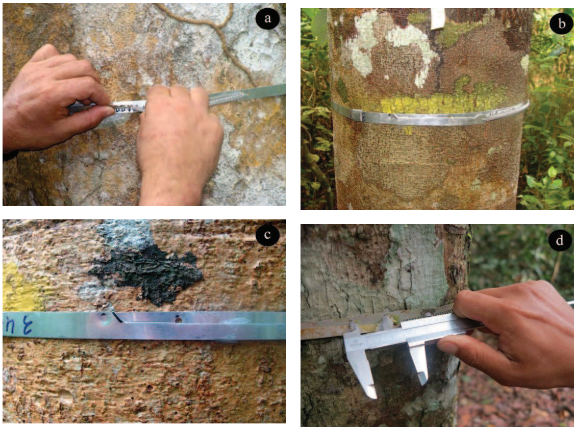
Figura 1. Instalação da cinta dendrométrica (a); cinta dendrométrica instalada e ajustada no fuste da árvore (b); detalhe mostrando os orifícios de medição das variações do crescimento (c); e medição da distância entre os orifícios com paquímetro (d). Fotos: próprio autor.
