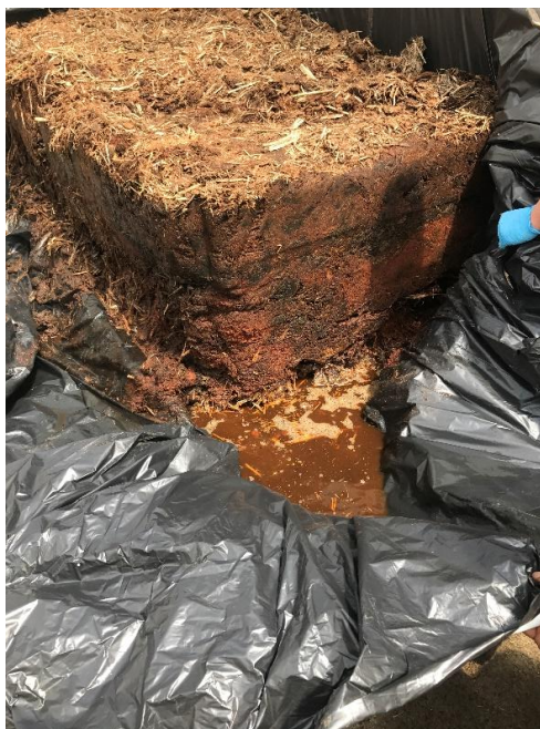
Figura 3- Chorume gerado pela leira de compostagem 1 sendo coletado
